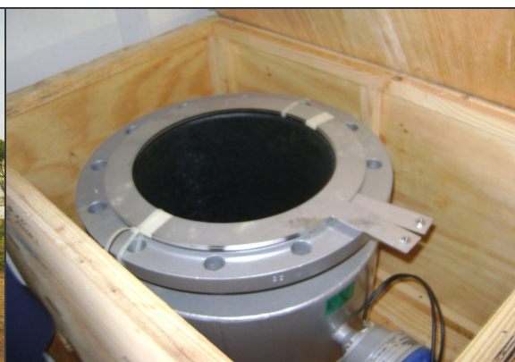
Foto 11 – Um dos novos macromedidores que será instalado.
