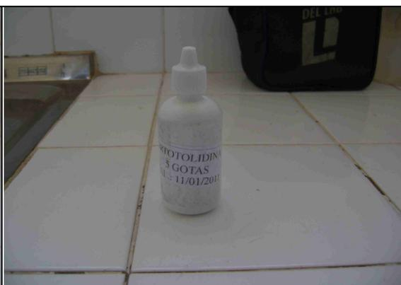
**Foto 51** – Reagente químico Ortotolidina utilizado nas análises de cloro residual (dentro do prazo de validade - 11/01/2011).
