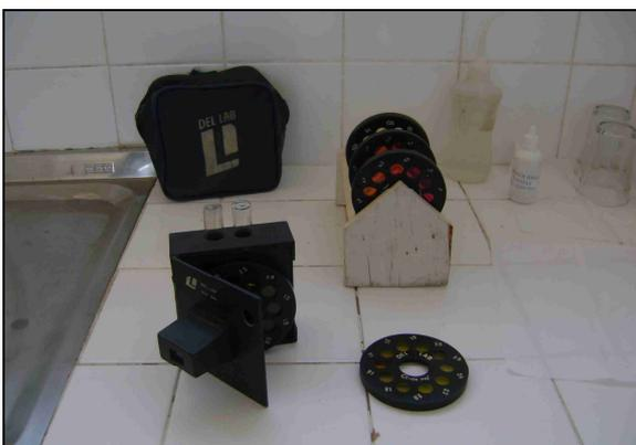
**Foto 50** – Comparador de disco colorimétrico para cloro residual, discos com intervalos de 0,5 a 10,0 mg/L.
