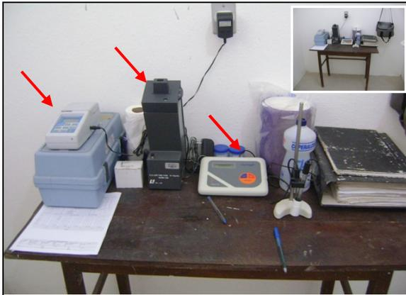
**Foto 18** – Laboratório: Equipamentos turbidímetro, colorímetro e pHmetro.
