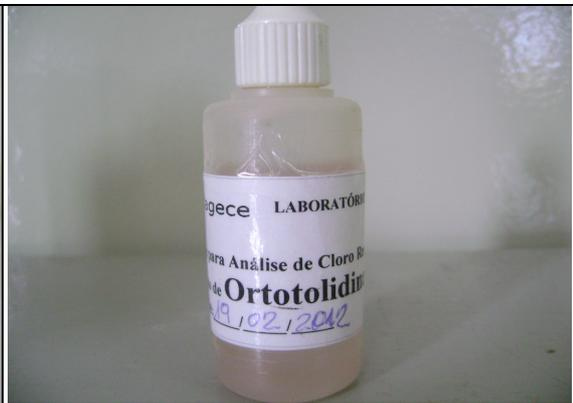
**Fotos 21** – Reagente químico Ortotolidina utilizado nas análises de cloro residual (dentro do prazo de validade – 19/02/2012).
