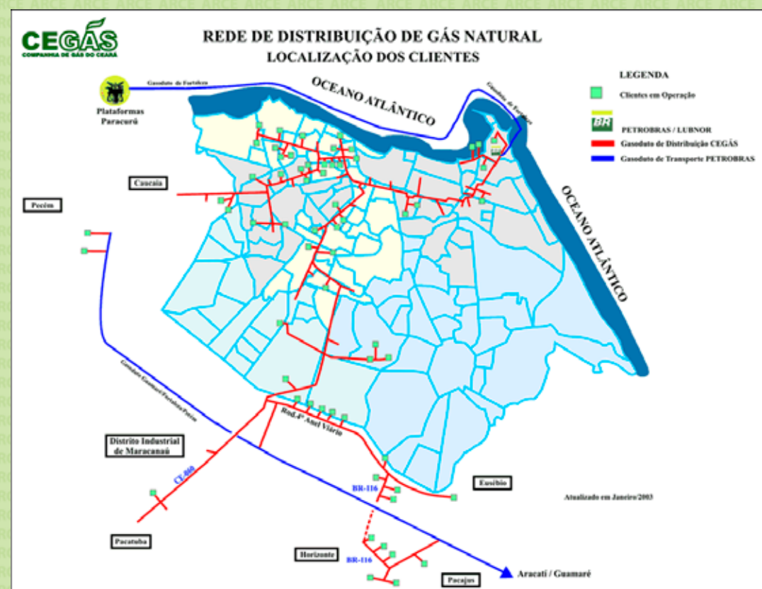
Figura 1 - Esquema da Rede de Distribuição de Gás Natural - Fortaleza e Região Metropolitana. Gasodutos da Supridora (PETROBRAS) e da Concessionária (Cegás) Fonte: Cegás
