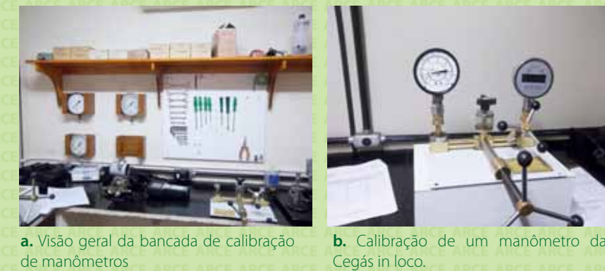
Figura 10. Fotografias do Laboratório de Pressão da M&M Instrumentação. Fonte: Arce
