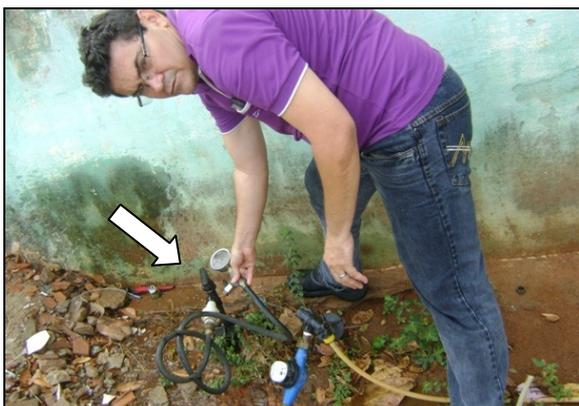
**Foto 56** – Medição de pressão na Rua Luis Monteiro, 18 – Suate, sem hidrômetro.
