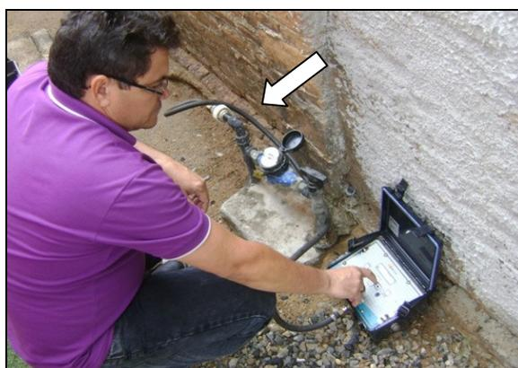
**Foto 58** – Medição de pressão na Rua D, 10 – Conjunto Paraíso, sem hidrômetro.
