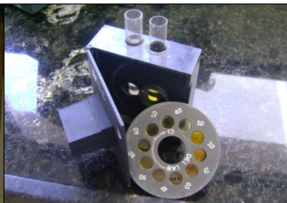
Foto 19 – Colorímetro e disco comparador.
