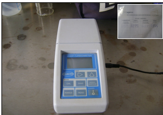
Foto 13 – Turbidímetro e ficha de controle do equipamento.
