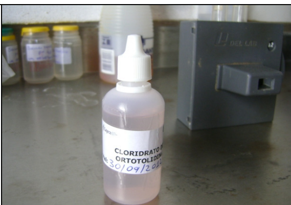
Foto 12 – Reagente químico Ortotolidina utilizado nas análises de cloro residual (dentro do prazo de validade – 30/9/2012).
