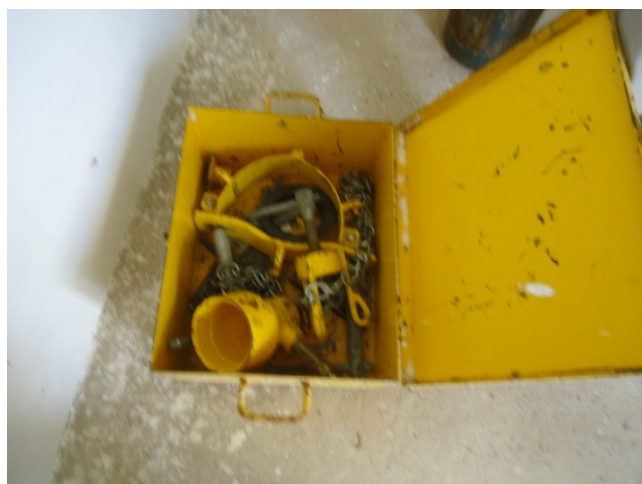
Foto 18 – Kit de emergência do equipamento de cloro gasoso.
