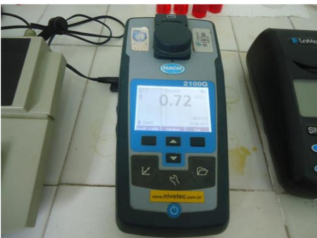
Foto 20 – Equipamentos - turbidímetro.
