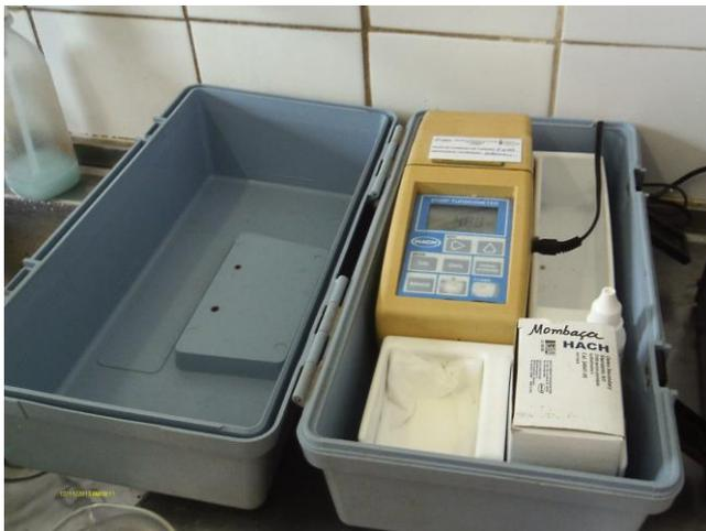
**Foto 33** - Laboratório: equipamento turbidímetro.
