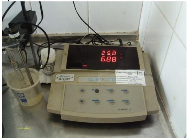
**Foto 34** - Laboratório: equipamento pHmetro.
