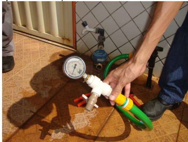
Foto 50 – Medição de pressão na Rua Francisco Mourão Lima, FNS-931 – Centro.
