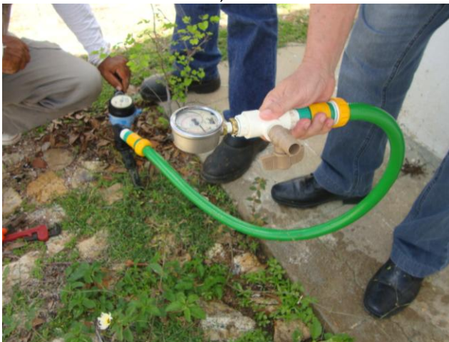
Foto 51 – Medição de pressão na Rua Manuel Linhares (CAGECE).
