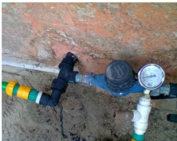
Foto 12 – RDA: medição instantânea de pressão na Rua Bismark Sá 02, 56 – Precabura.
