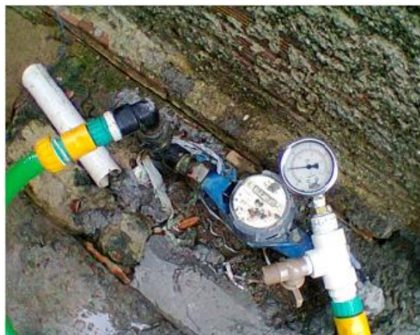
Foto 10 – RDA: medição instantânea de pressão na Rua Raimundo Pio Campina, 161 – Tamadantuba.
