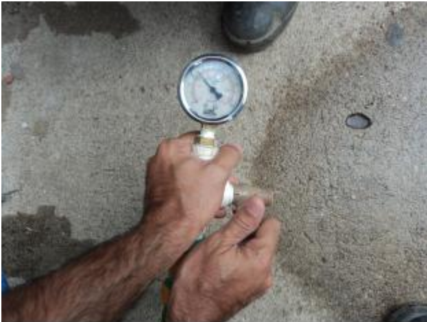
Foto 91 – RDA: medição instantânea de pressão na R. Manoel Pinheiro de Almeida – Centro.
