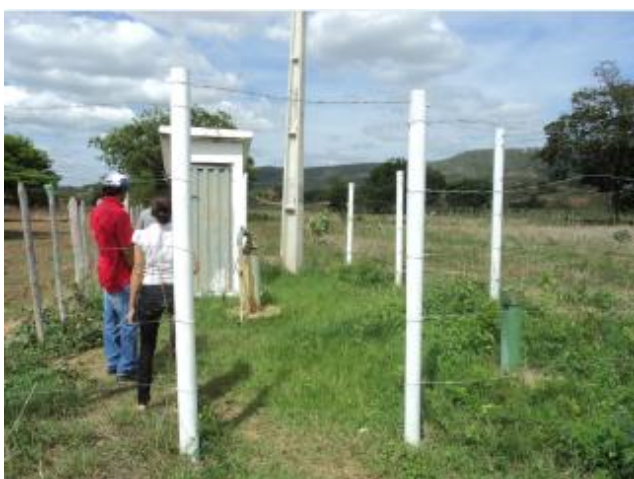
Foto 27 – PT-04: ausência de portão.
