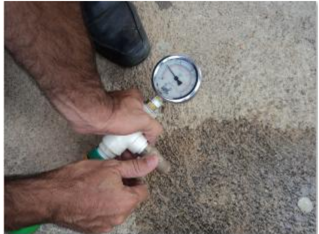
Foto 92 – RDA: medição instantânea de pressão na R. Liberalino Duarte Brandão, FA524 – Centro.
