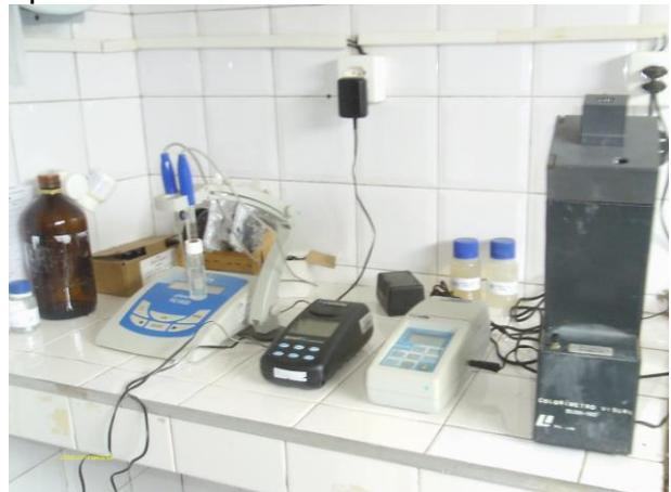
**Foto 21** - Laboratório: equipamentos pHmetro, turbidímetro, fluorímetro e colorímetro.
