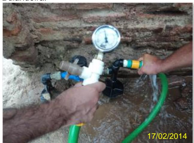
**Foto 118** – RDA: medição instantânea de pressão na R. Cônego Demetrius, 53 – Vazantes.
