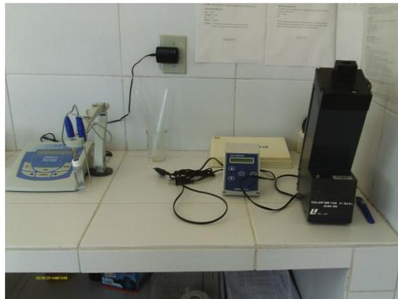
Foto 13 - ETA: equipamentos para realização de ensaios físico-químicos (pH, cor e turbidez).
