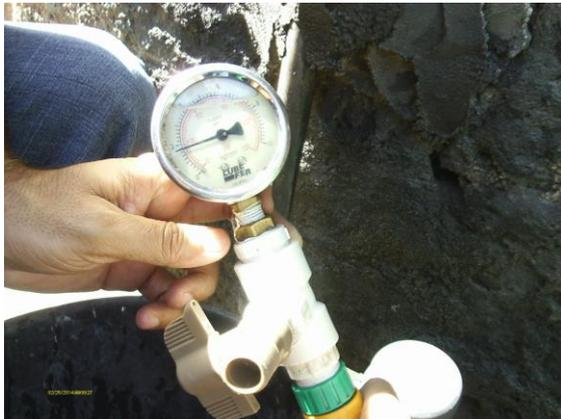
**Foto 48** - Medição instantânea de pressão na rede de distribuição: Av. Humberto Bezerra, FNS 07.
