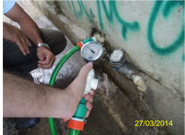
Foto 47 – RDA: medição instantânea de pressão na R. Delfino Ferreira, SMS 177 – Nossa Senhora das Graças.
