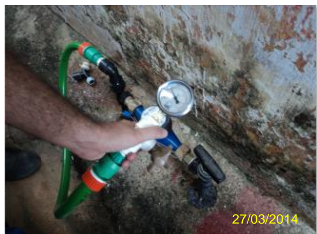
Foto 45 – RDA: medição instantânea de pressão na R. Antônio Ferreira, 118 – Sagrado Coração de Jesus.
