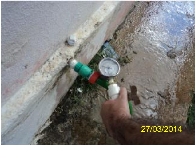
Foto 46 – RDA: medição instantânea de pressão na R. Vicente Barbosa, SMS 166 – Nossa Senhora das Graças.
