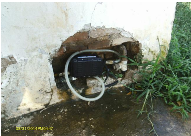
Foto 48 – Medição de pressão com instalação às 17:00h do dia 31/03/14 e retirada às 17:00h do dia 01/04/14, com aparelho datalogger na Rua Juca Farias, nº 28 (FNS).
