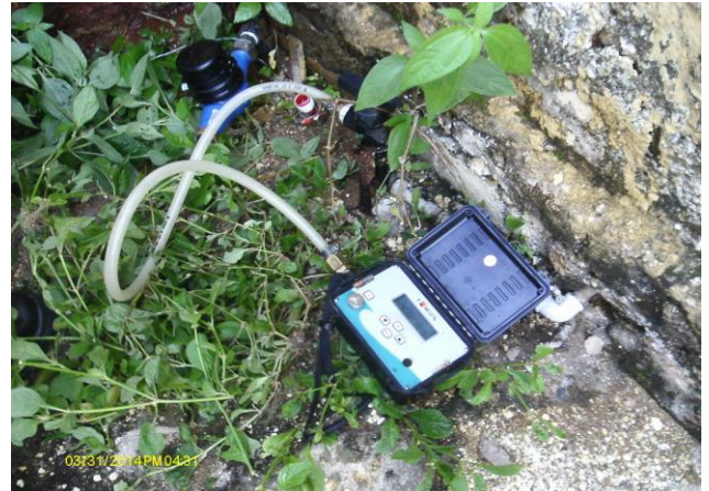
Foto 47 – Medição de pressão com instalação às 16:30h do dia 31/03/14 e retirada às 16:30h do dia 01/04/14, com aparelho datalogger na Rua Coronel Liberalino Carvalho, nº 156.
