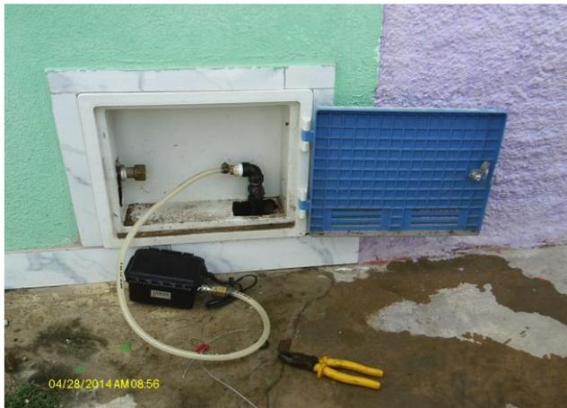
**Foto 61** – Medição de pressão com instalação às 9:30h do dia 28/04/14 e retirada às 9:30h do dia 29/04/14, com aparelho *datalogger* na Rua Alexandre Melo, nº 332 - Centro.
