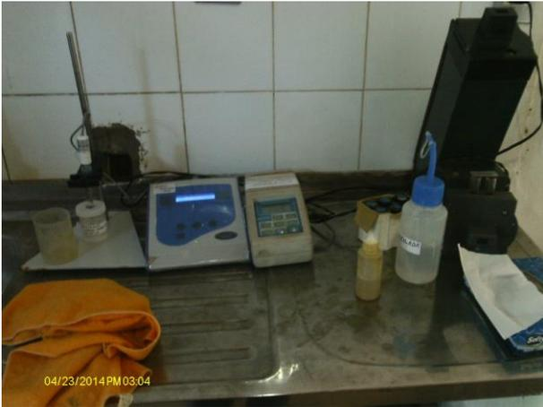
**Foto 25** - ETA/Laboratório: equipamentos pHmetro, turbidímetro e colorímetro calibrados.
