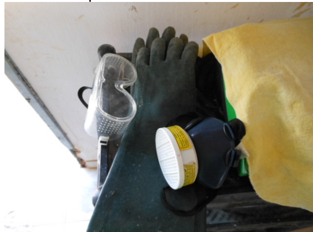
Foto 12 - Casa de Química: EPIs do operador.
