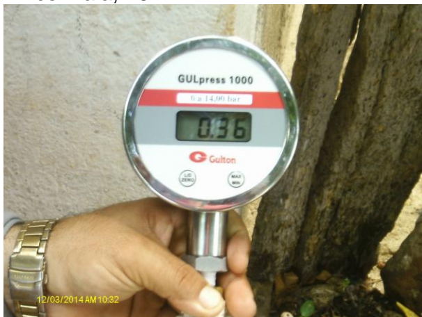
Foto 5 - Medição instantânea de pressão na rede de distribuição: Rua José Sabino Mendes, 1375.
