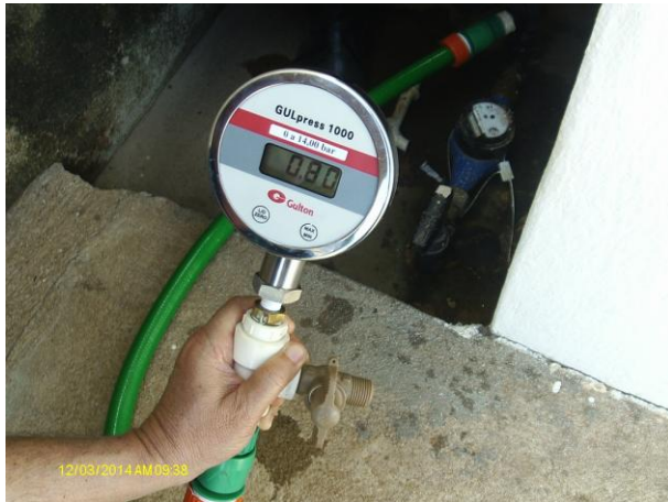
Foto 1 - Medição instantânea de pressão na rede de distribuição: Travessa Inácio Mendes, 378.
