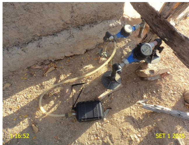
Foto 1 – Aparelho datalogger instalado no endereço localizado na Rua Bernardo de Lima, 679 (SMS) – Empréstimo.
