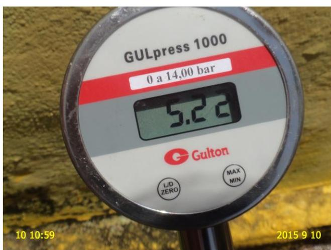
**Foto 2 -** Medição instantânea de pressão na rede de distribuição no endereço localizado na Rua do Açude, FNS 12.
