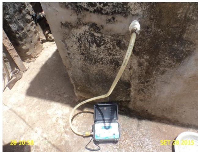
**Foto 23** – Aparelho *datalogger* instalado no endereço localizado na Travessa do Estádio 2, nº 11.
