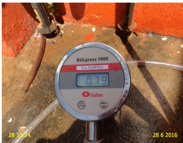
Foto 1 – RDA: Medição de pressão instantânea na rede de distribuição – Rua Gonçalves Vidal, nº 160 - Centro.
