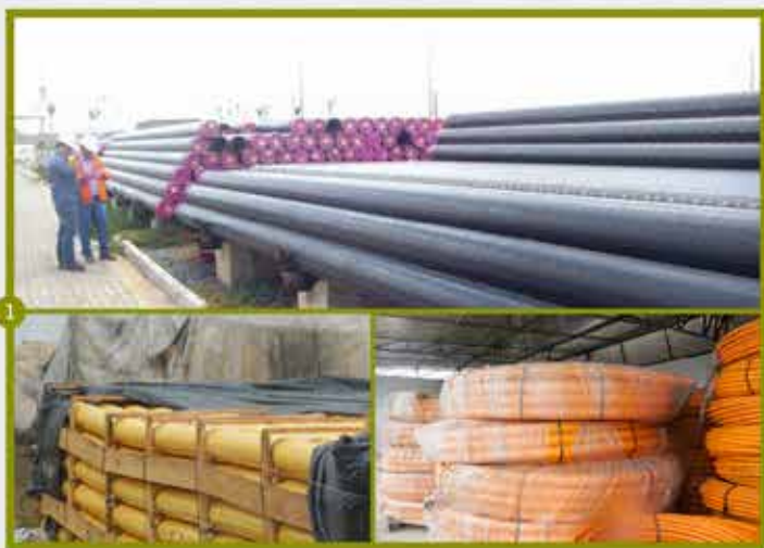
Foto 1 - Pátio de Dutos – Estoque de dutos tipo aço e PEAD
