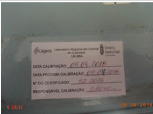
**Foto 91** – ETA/Laboratório (Ideal): equipamento turbidímetro com data da calibração vencida.
