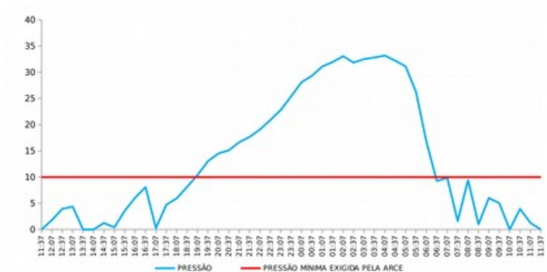
**Gráfico 2** - Monitoramento da pressão no SAA da Localidade de Ideal, com a instalação às 09:55 horas do dia 06/06/2018 e retirada às 10:25 horas do dia 07/06/2018, do aparelho *datalogger*, no endereço localizado Rua Vila Nova, nº 14.
