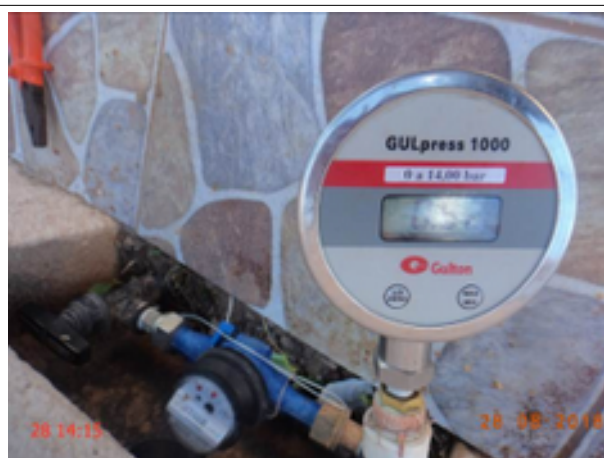
Foto 2 – RDA: medição instantânea de pressão no endereço: Rua Parque de Vaquejada s/n.
