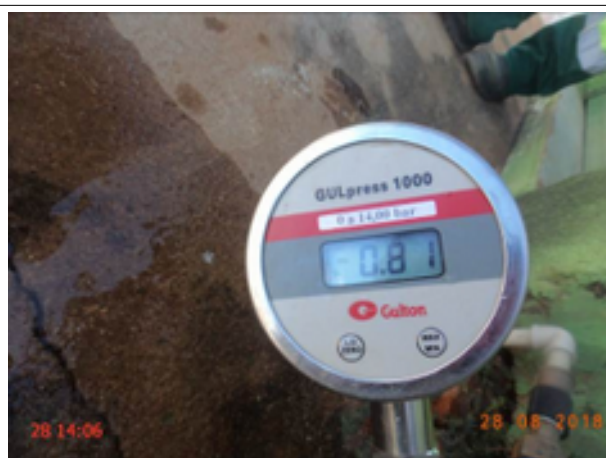
Foto 1 – RDA: medição instantânea de pressão no endereço: Rua Francisco Ramalho Sobrinho, 441.
