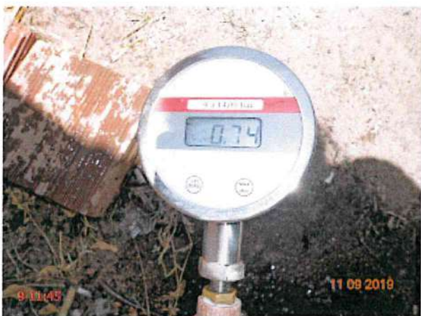
Foto 7 – RDA (Jardim de São José): pressão instantânea fora da faixa de 10 a 50 mca na Rua Raimundo Batista S. de Filho, SMS 300.
