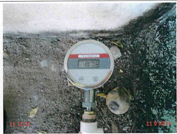
Foto 2 – RDA (São João de Deus): pressão instantânea fora da faixa de 10 a 50 mca na Rua Padre Agostinho s/n.
