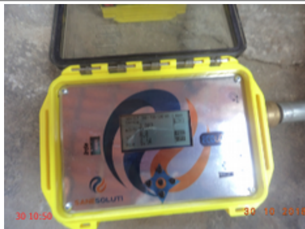
Foto 59 – RDA (Sede): medição contínua de pressão no endereço localizado na Avenida Adauto Medeiros, SMS 6.
