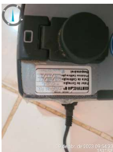
Foto 96 - Laboratório (Siupé): turbidímetro com data de calibração vencida.
