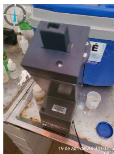
Foto 97 - Laboratório (Siupé): colorímetro sem funcionar.
