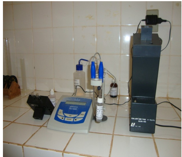
Foto 22 – Equipamentos de ensaios físico-químicos em adequado estado de conservação.
