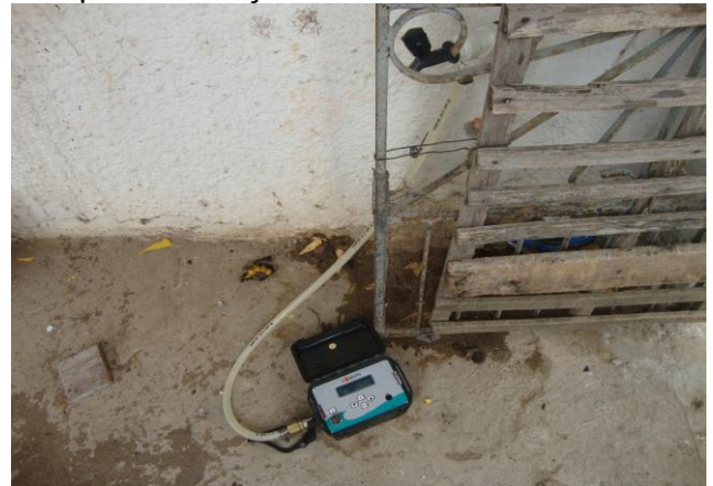
Foto 80 – Medição de pressão com instalação às 13:40h do dia 16/12/13 e retirada às 13:10h do dia 17/12/13, com aparelho datalogger na entrada para Pacujá, s/n – Cariré Velho.
