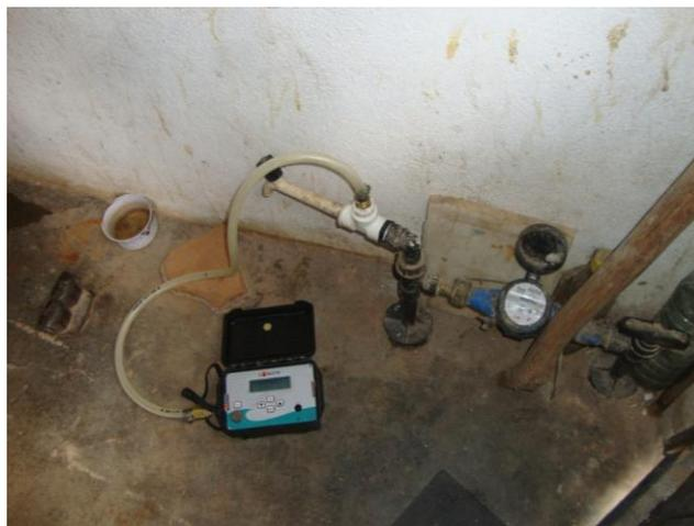
**Foto 77** – Medição de pressão com instalação às 14:20h do dia 17/12/13 e retirada às 13:50h do dia 18/12/13, com aparelho *datalogger* na Rua João Guarino Feijão, nº 23 – Capitão Linhares.
