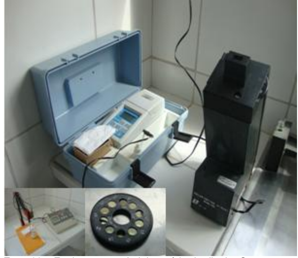
Foto 44 – Equipamentos do laboratório do distrito Campestre e disco de cloro com valor máximo de 3,0 mg/l.
