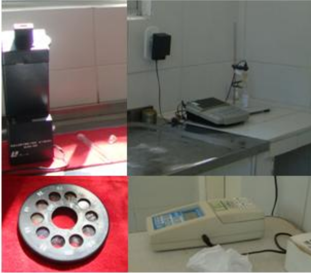
Foto 43 – Equipamentos do laboratório do distrito Sede e o disco de cloro com valor máximo de 3,0 mg/l.
