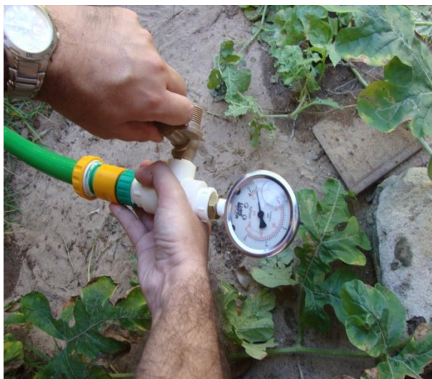
Foto 85 – Medição de pressão na Av. 27 de maio, nº 1190 – Maceió.
