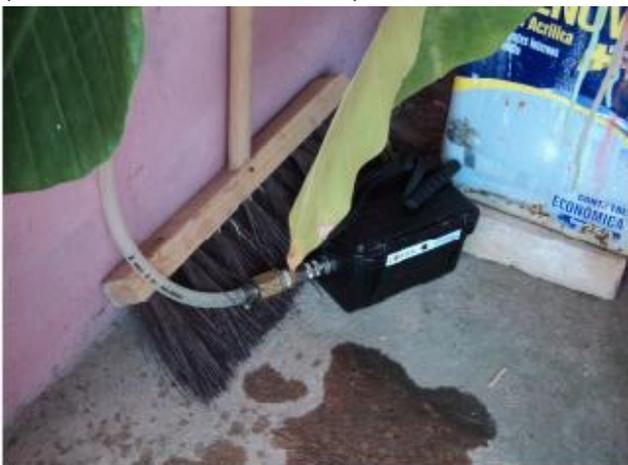
**Foto 63** – RDA: medição contínua de pressão com datalogger na Rua B, 97 – COHAB.
