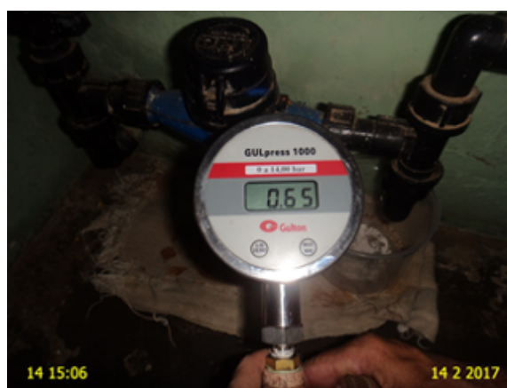
Foto 2 – pressões fora da faixa de 10 a 50 mca na Rua Pereira Filgueiras, 97 – Centro.
