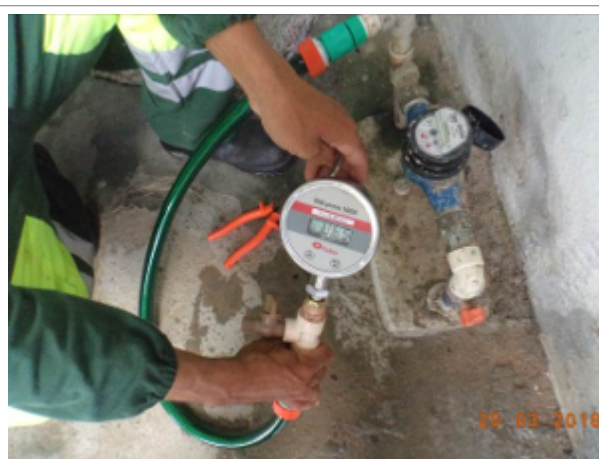
Foto 53 – RDA: medição de pressão instantânea no endereço localizado na Rua Estevão Carvalho, SMS 124 – Choró, Beberibe.
