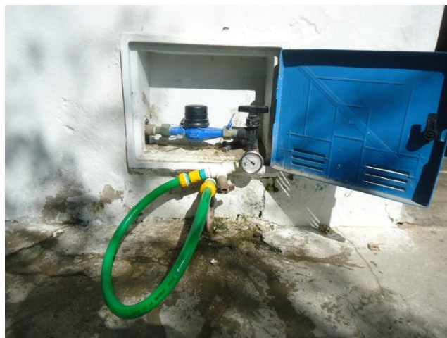
Foto 62 – Medição instantânea de pressão disponível na rede de distribuição – Rua Nossa Senhora de Fátima, 64.
