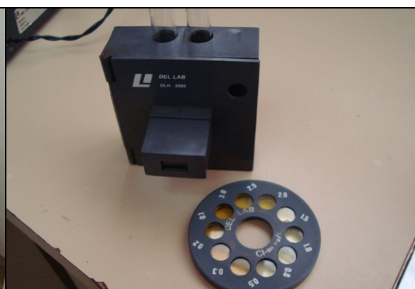
Foto 18 – Clorímetro e disco comparador.
