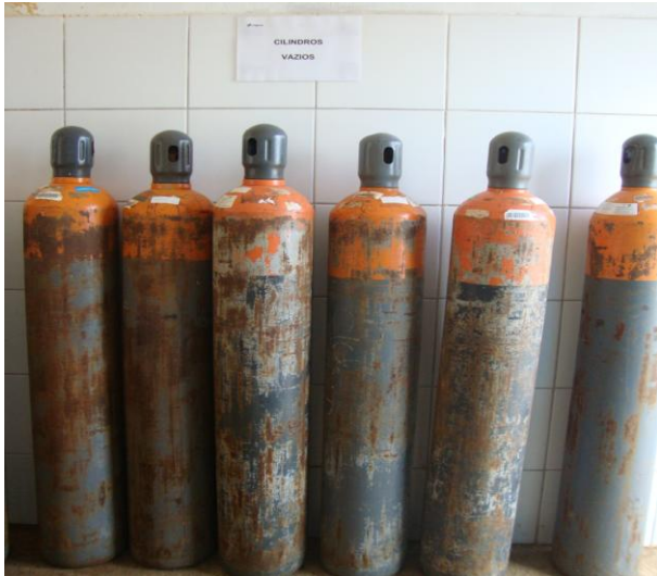
Foto 33 – Cilindros de cloro gasoso.
