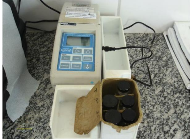
**Foto 13** - Laboratório: equipamento turbidímetro calibrado.
