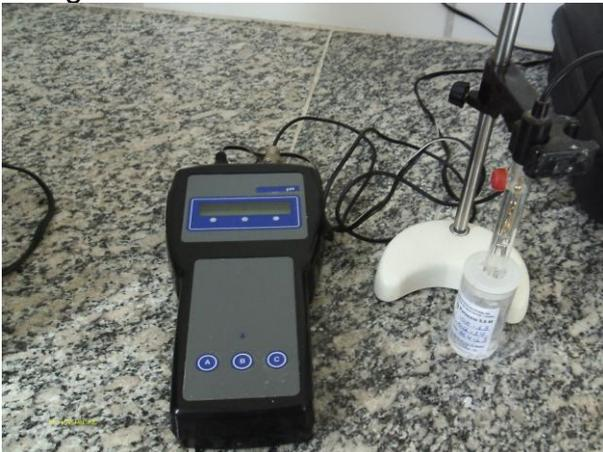
**Foto 14** - Laboratório: equipamento pHmetro calibrado.
