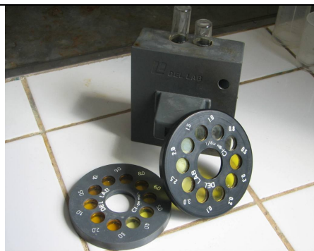
Foto 23 – Discos de cloro com valores máximos de 3,0 e 10 mg/l.
