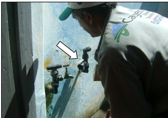
Foto 60 – Medição de pressão na Rua Antônio Liberalino de Menezes, 52 - Centro, antes do hidrômetro.
