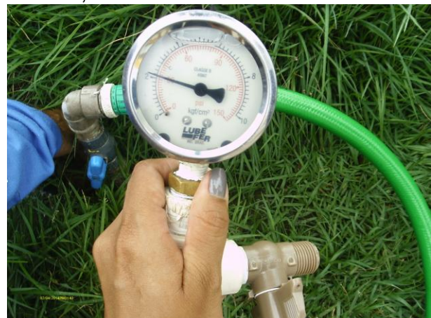
Foto 41 - Medição de pressão instantânea na rede de distribuição: Praça Ant. Lisieux Feitosa.
