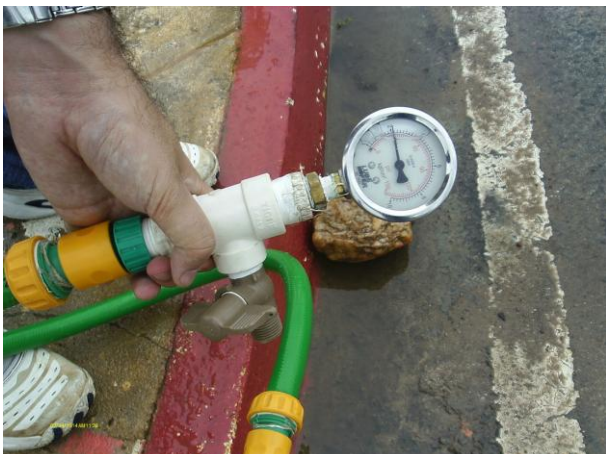
Foto 40 - Medição de pressão instantânea na rede de distribuição: Hospital Municipal.
