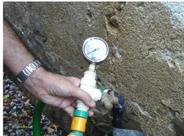
Foto 39 - Medição de pressão instantânea na rede de distribuição: Rua Fco Sales Feitosa, 24.
