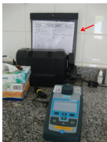
Foto 36 – Aparelho de turbidímetro com ficha de calibração.
