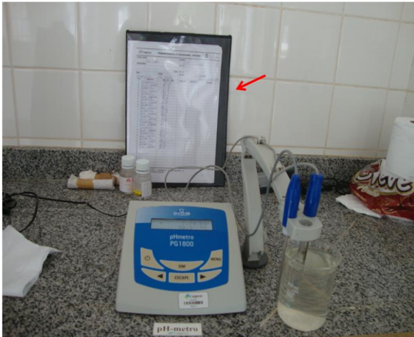
Foto 37 – Aparelho de pH com ficha de calibração.
