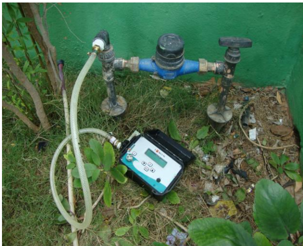
Foto 85 – Medição de pressão com instalação às 13:00h do dia 24/06/13 e retirada às 13:00h do dia 25/06/13, com aparelho datalogger na Av. 7 de Setembro, nº 1285, Alto da Boa Vista.
