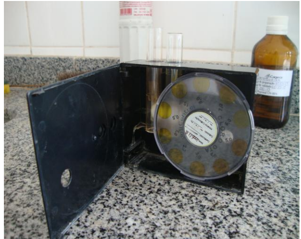
Foto 38 – Clorímetro e disco comparador.
