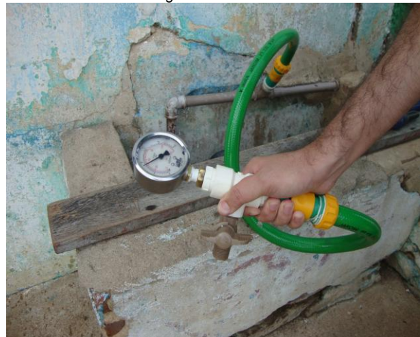
Foto 84 - Medição de pressão instantânea na Rua Passagem Angelim, nº 431 - Centro.
