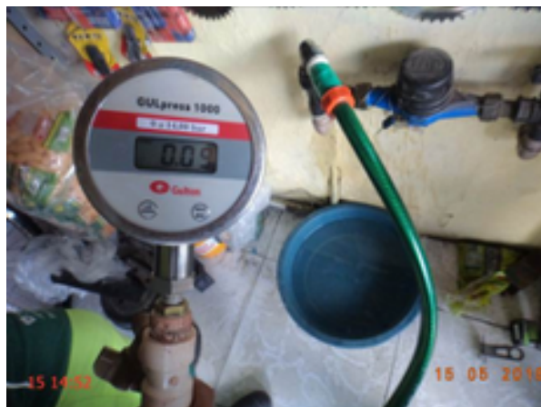
Foto 6 – RDA: medição instantânea de pressão no endereço Av. Paraná, nº 288 – Romeirão.
