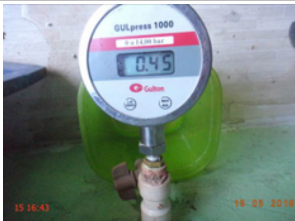
Foto 9 – RDA: medição instantânea de pressão no endereço Rua Ministro Colombo de Sousa, nº 260.
