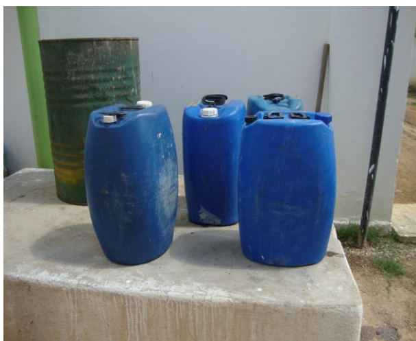
Foto 29 – Armazenamento de polímero inadequado.
