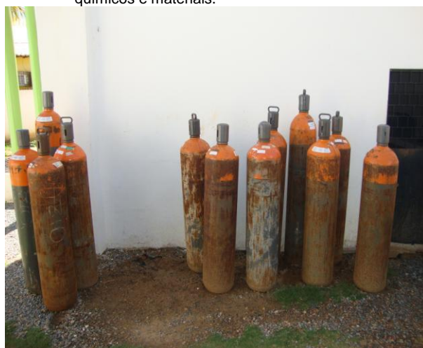
Foto 30 – Armazenamento de cloro gasoso inadequado.
