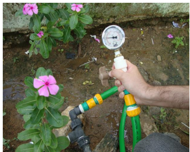
Foto 77 – Medição de pressão instantânea na Vila Mocó, nº 55 – Trizidela.
